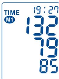
После окончания измерения над показателями давления высвечивается время, а слева M1 или M2. M1 соответствует результатам измерения первого лица. В M2 могут быть сохранены результаты измерения второго лица (смотри пункт 5.1. Сохранение результатов измерения).
